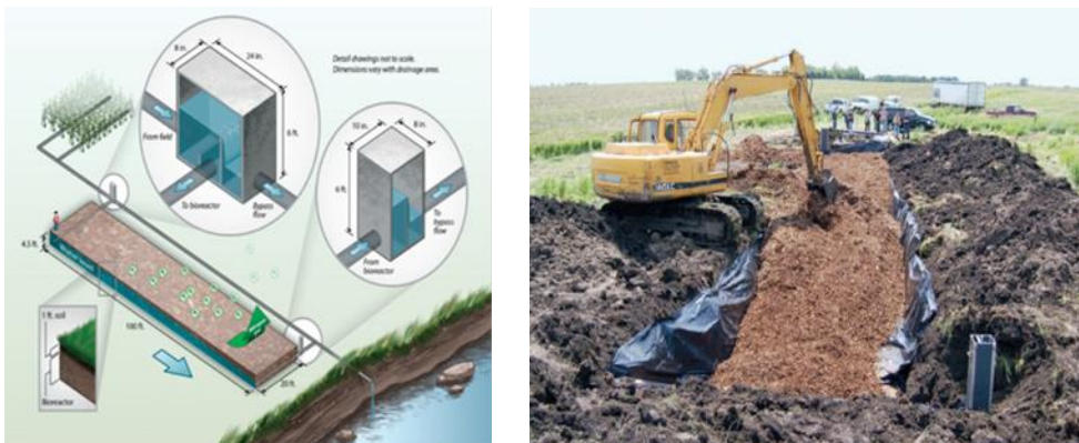
Figuur 1: Woodchip bioreactor.
