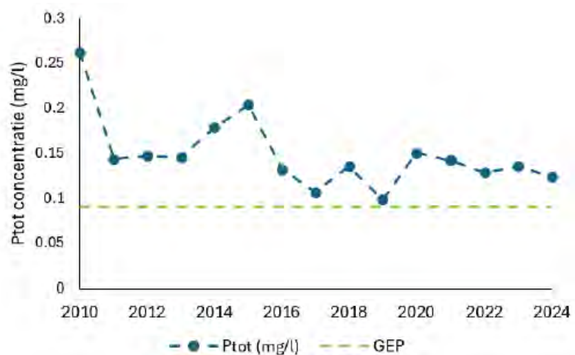
Figuur 139. De gemeten fosforconcentraties (zomergemiddeldes per jaar) in de loop der jaren in het Leekstermeer.
